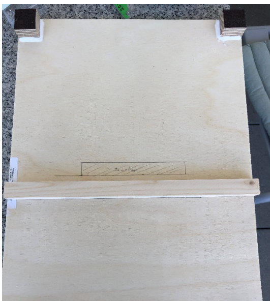
Seitenwand mit Holzwürfeln, sowie mit Leiste für Regalbrett und Markierung für den Drucker-Ausschnitt.
