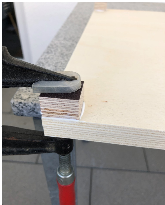
Holzwürfel in den Ecken zur Fixierung der Seitenteile.
