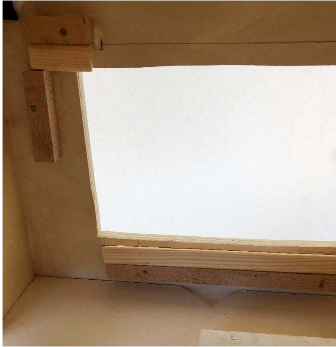
Öffnung für das Tablet mit "L"-Leiste für die Fixierung
